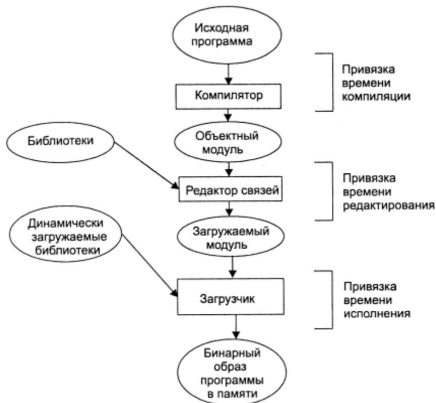
Рис. 7.13. Привязка адресов
